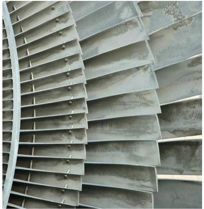
La deposizione di silice sulle palette delle turbine è un problema di importanza cruciale
