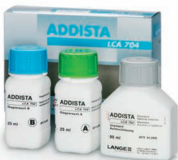
Fig. 11: ADDISTA con materiale di riferimento/di spiking e due soluzioni incognite per il controllo della precisione e della accuratezza dei risultati.
