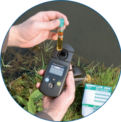
Fig. 7: Eseguire un'analisi sul campo mediante la semplice pressione di un pulsante: POKET Colorimeter II a parametro singolo.
