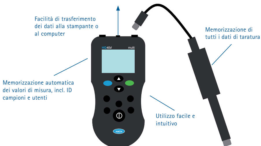
Fig. 1: Rappresentazione schematica di HQD con le sue funzioni fondamentali.
