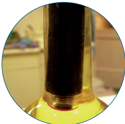
Figure 2 e 3: Misurazione dell'ossigeno con sensore HQD e LDO direttamente nella bottiglia.
