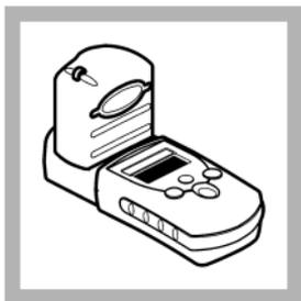
5. Montare il coperchio dello strumento sul vano cella.
