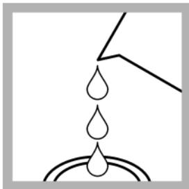
2. **Bereiten Sie die Blindlösung vor:** Füllen Sie die Küvette mit 10 ml der Blindlösung (für gewöhnlich Probenlösung).
