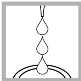
9. Ajoutez le réactif dans la seconde cuve à échantillon. Patientez jusqu'au développement complet de la couleur, le cas échéant.
