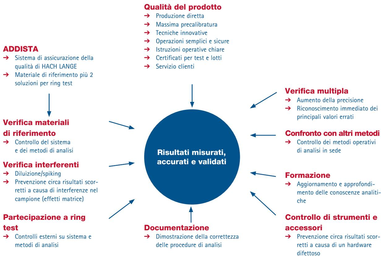
Fig. 2: Diversi metodi di controllo della qualità e loro vantaggi
